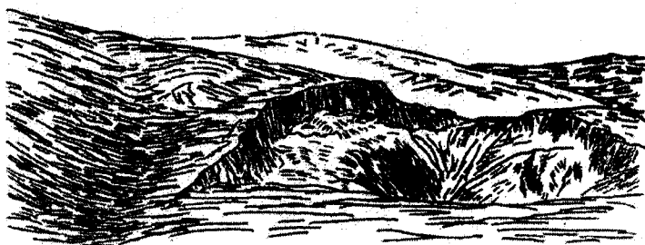
Рис. 1. Ров обрушения над отработанным до глубины 600 м от поверхности участком Таштагольского месторождения железной руды (Горная Шория). Слева – лог Нагорный, выработанный эрозией по одноименной дизъюнктивной зоне межсекционного ранга. Вид с северо-северо-запада (с полевой зарисовки автора)
