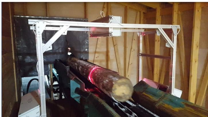
Рис. 6: Лазерный 3D-сканер
