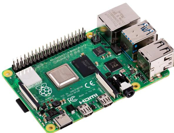
Рис. 7: Плата Raspberry Pi 4
