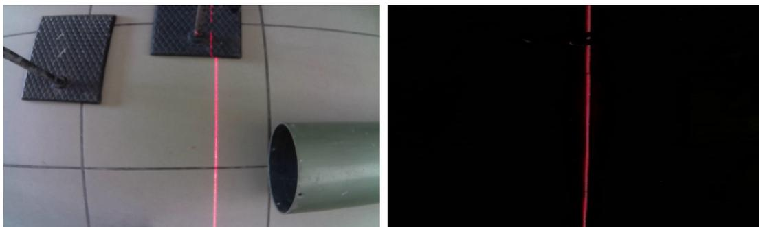
Рис. 22: Кадр без использования фильтра (слева) и кадр с использованием оптического фильтра (справа)
