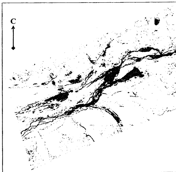
Рис. 2. Результат классификации снимка QickBird по каналам видимого спектра ( RGB ) с помощью алгоритма кластерного анализа Isodata
