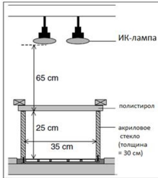
Рис. 4.2: Схема экспериментального контейнера [64]
