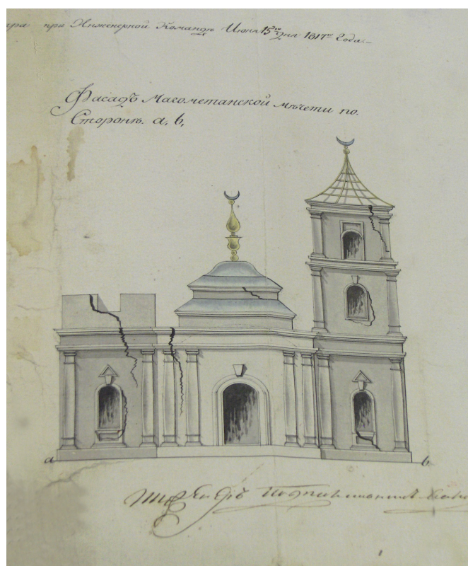
Рис. 2. Фасад каменной мечети Петропавловской крепости с повреждениями (ГАОО. Ф. 3. Оп. 1. Д. 359. Л. 60)
