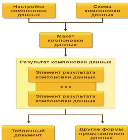
Рисунок 2 – Основные элементы системы компоновки данных
