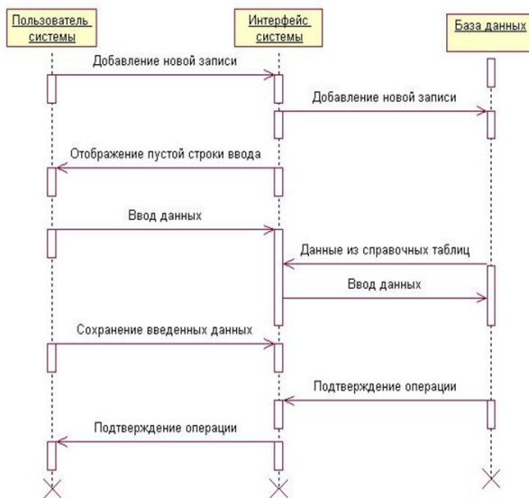
Рисунок 8 – Диаграмма последовательности при добавлении новой записи
